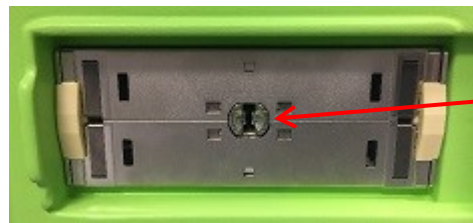
Figure 7 : Encoche de verrouillage sur le compartiment du connecteur de la sonde
