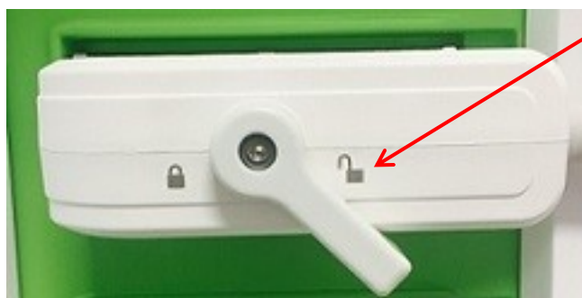
Figure 9 : Bouton de verrouillage du connecteur de la sonde déverrouillé
